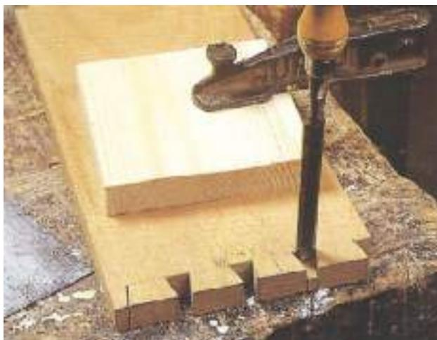
6. Em cada uma das esquinas desta gaveta produzir-se-á uma união a meia madeira, de modo a que as respigas de cauda de andorinha não sejam visíveis da parte frontal. Assim, a samblagem realiza-se por forma a assegurar uma boa resistência perante a tração que se aplicará nesta parte da gaveta.
