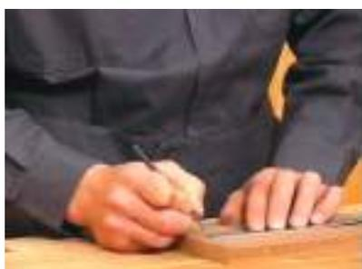
Nesta operação pega-se no riscador de forma a fazê-lo deslizar na madeira com precisão e suavidade em direção ao operador e com a inclinação adequada. O riscador é o instrumento mais adequado à marcação de madeiras escuras devido à visibilidade que se obtém.
