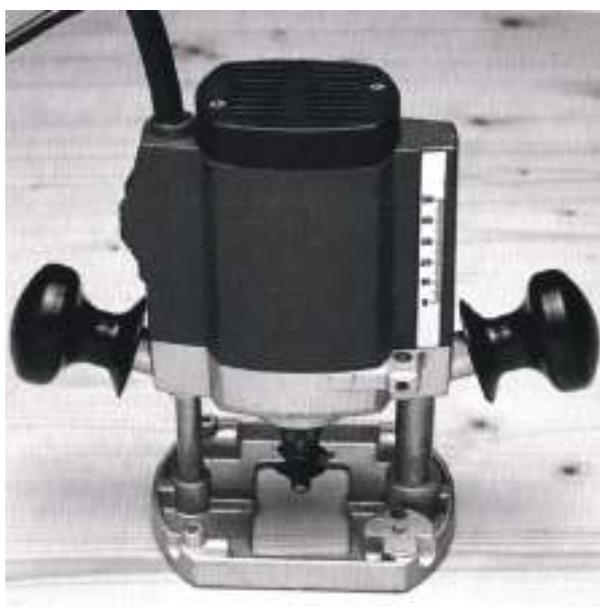
Estas máquinas são fabricadas com materiais ligeiros, tais como o plástico duro e o alumínio. De um modo geral, são dotadas de um motor monofásico de 500 a 1500 watts, o que proporciona aos seus eixos de rotação velocidades entre as 3550 e 20 000 rotações por minuto, características que, aliada ao seu baixo peso, permite considerá-las como autênticas ferramentas mecânicas e manuais e, enquanto tais,
