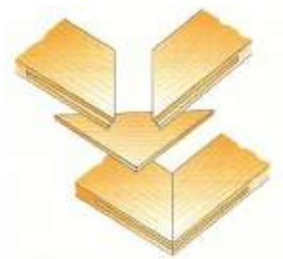
Efetua-se dois cortes de serra a esquadria, vazando com o escopro a parte que será preenchida pela espiga correspondente. Este tipo de samblagem proporciona um bom resultado, sendo muito resistente, ao dispor de uma superfície maior para alojar cavilhas, parafusos, etc.
