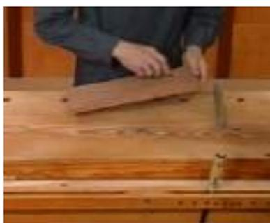
Os riscadores também podem ser usados para traçar contornos previamente definidos por gabaritos (moldes ou modelos). A operação de marcar com o **riscador** inicia-se, tal como o lápis, pela seleção e referenciação com **sinais convencionais** da face e do canto da peça. A seleção da face e do canto deve ser feita tendo em
