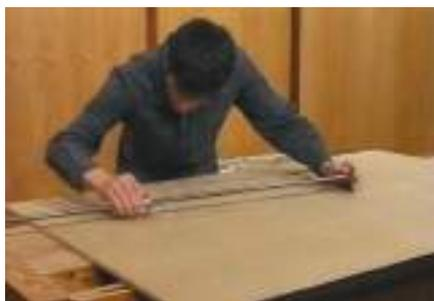
Quando as dimensões excedem as capacidades do compasso utiliza-se o cintel.
